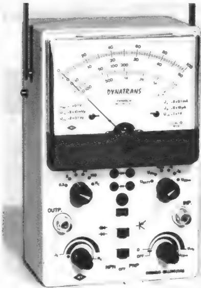
Bild 1. Transistorprüfgerät Dynatrans
