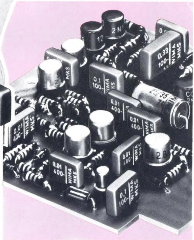
**WIMA-MKS** Metallisierte Polyester-Kondensatoren. Geringste Abmessungen. Betriebssicher. In der Bauform günstig für Leiterplatten.
