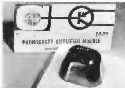
Bild 1. Kompletter Phonoverstärkermodul mit 2 W Ausgangsleistung für Kristalltonabnehmer
